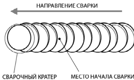
Рис. 11.5. Начало сварки при смене электрода.
